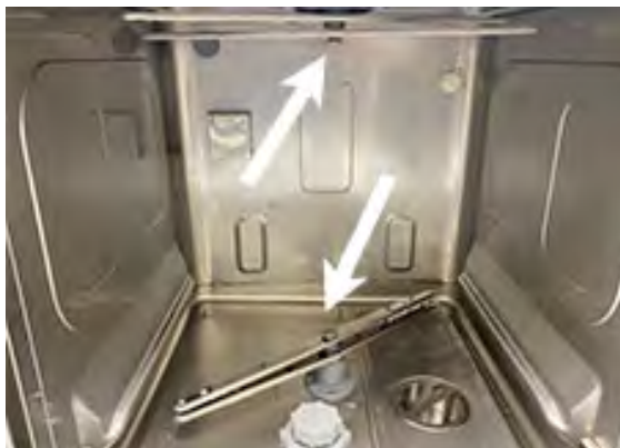
Bild 18 Nedre och övre disk- och spolarmar
