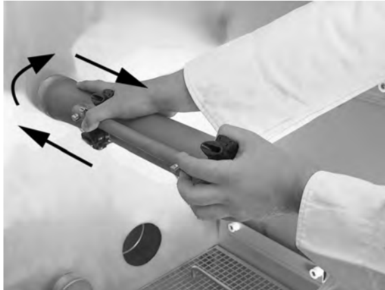
Bilde 30 Tilbakemontering av spylereøret
