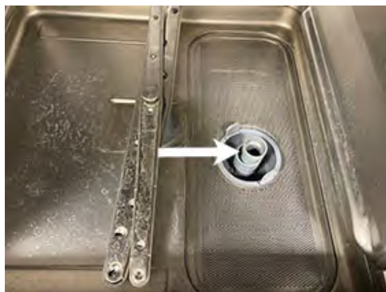
Fig. 10 Távolítsa el a túlfolyócsövet
