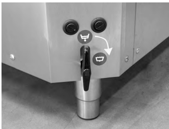
Photo 6 Vanne de remplissage
