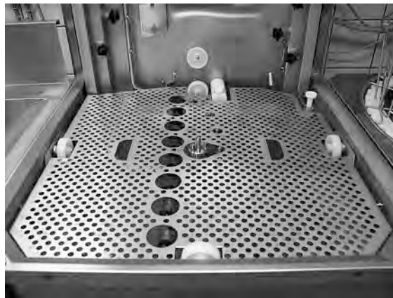
Photo 27 Grille du réservoir
