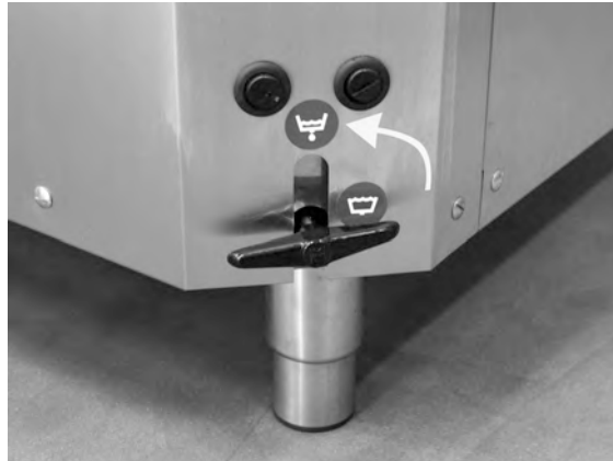
Photo 26 Vanne de remplissage
