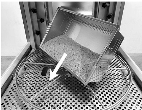
Fig. 5 A granulátum betöltése
