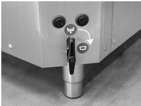
Photo 6 Vanne de remplissage
