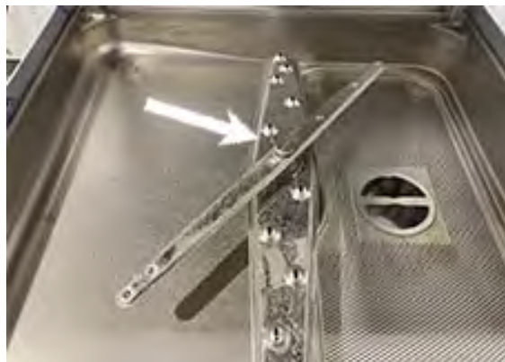
Kuva 14 Alemmat pesu- ja huuhteluvarret
