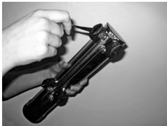
Fig. 24 A mosogatófűvókák megtisztítása
