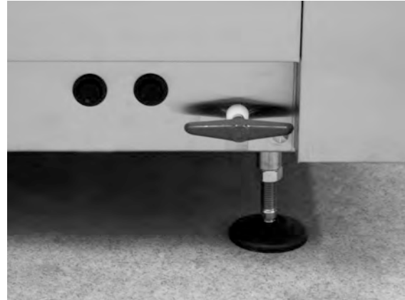
obraz 22 Dostęp do zabezpieczeń przed przegrzaniem
