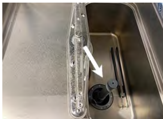
Figura 11 Rimuovere il tubo del troppo pieno
