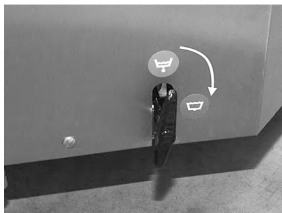
εικόνα 4 Άνοιγμα της βαλβίδας αποστράγγισης
