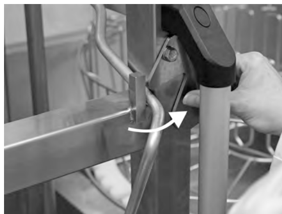
εικόνα 8 Ασφάλεια μηχανισμού κύλισης
