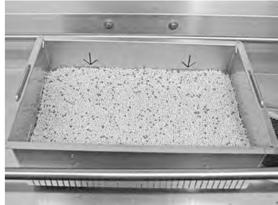
Figura 33 Controllare il livello dei Granuli
