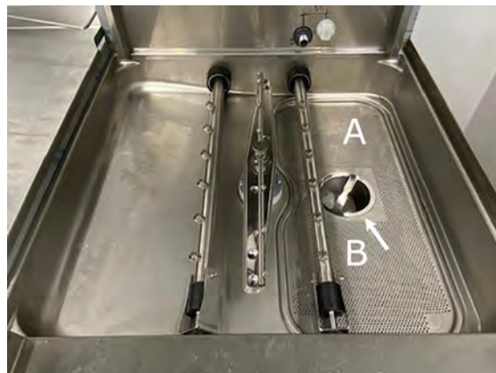
Bild 22 Ta bort tankgallret och filtret
