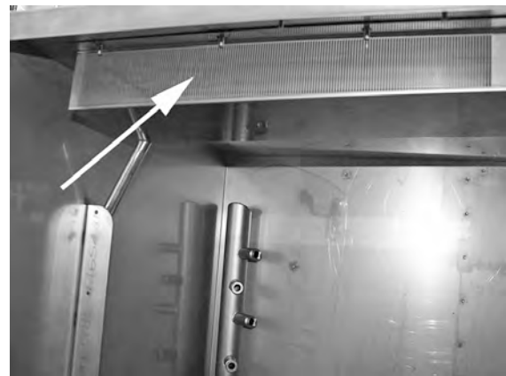
Billede 41 EcoExchanger set inde fra maskinhuset
