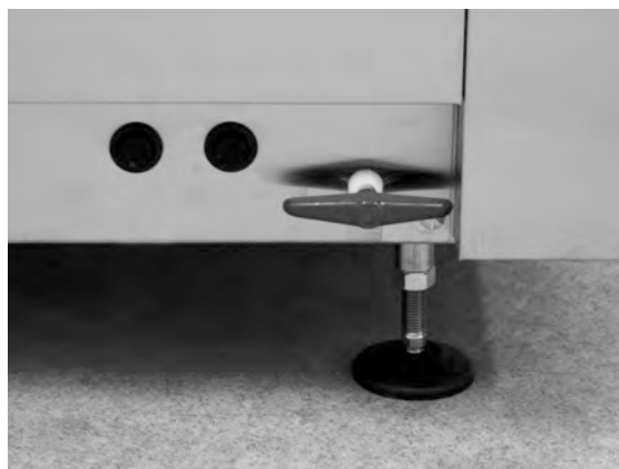
Billede 22 Adgang til overophedningssikringer
