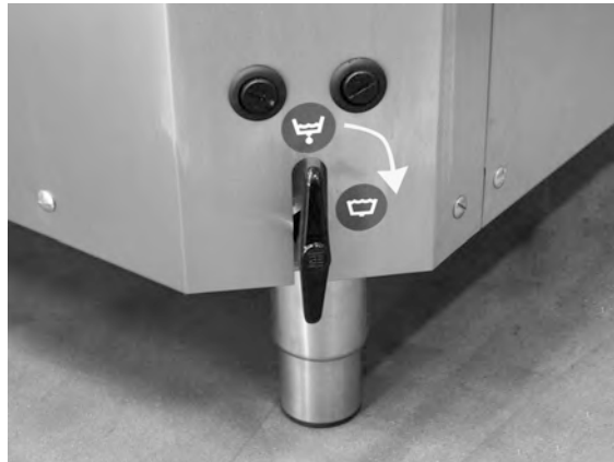
εικόνα 6 Άνοιγμα της βαλβίδας αποστράγγισης
