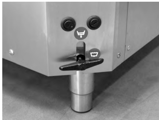
εικόνα 20 Πρόσβαση στους μηχανισμούς προστασίας από υπερθέρμανση
