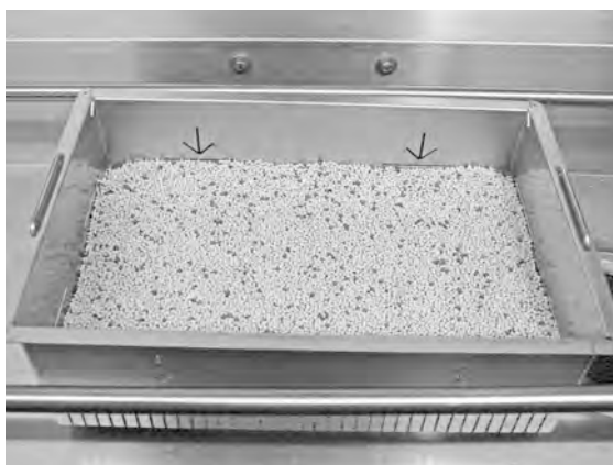
εικόνα 23 Έλεγχος της στάθμης των Granule
