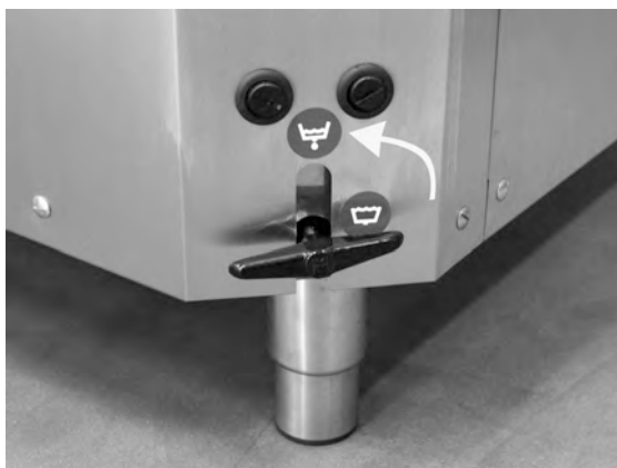
εικόνα 24 Άνοιγμα της βαλβίδας αποστράγγισης
