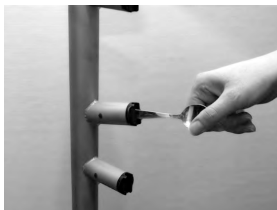
изображение 23 Очистка распыляющего сопла
