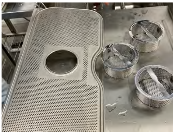
Photo 26 Nettoyer les filtres et la grille de la cuve
