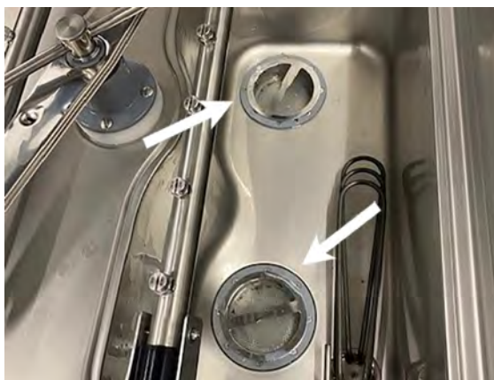
Photo 25 Retirer les filtres
