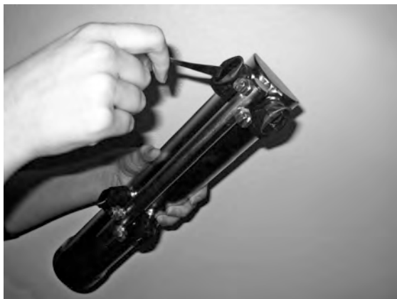
Photo 24 Nettoyage des buses
