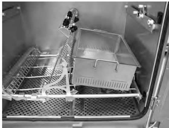
Photo 21 Collecteur de Granules dans la machine
