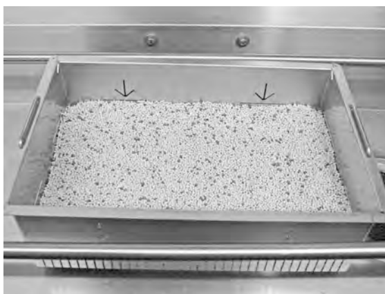
Obrázek 25 Kontrola hladiny granulí
