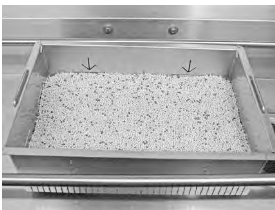
εικόνα 22 Έλεγχος της στάθμης των Granule
