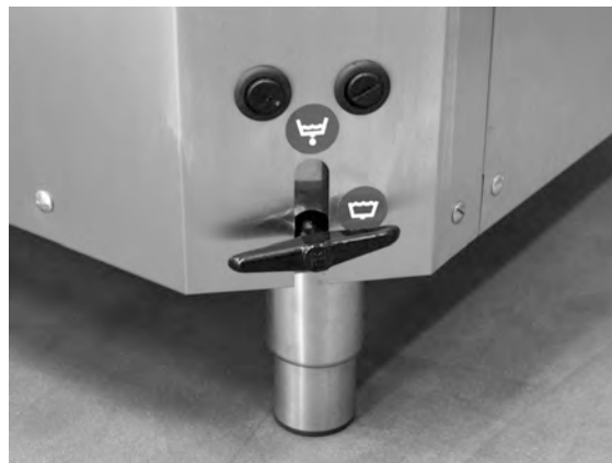
Imagine 20 Accesul la protecțiile de supraîncălzire
