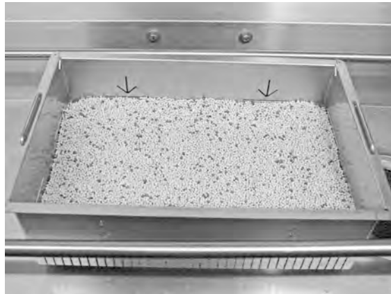
Figura 22 Controllare il livello dei Granuli
