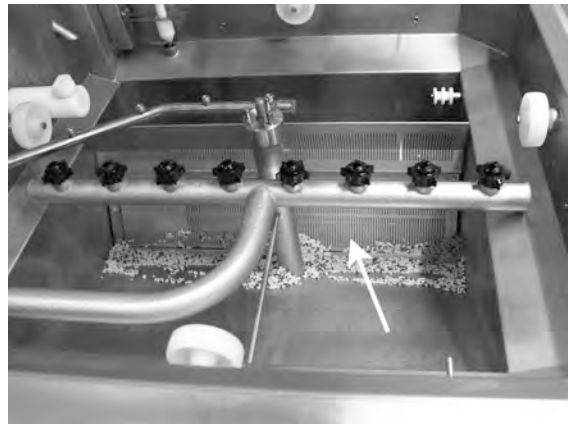
Abbildung 28 Den Granulatdämpfer reinigen.
