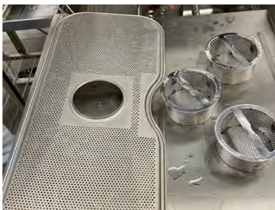
obraz 26 Wyczyść filtry i kratkę zbiornika
